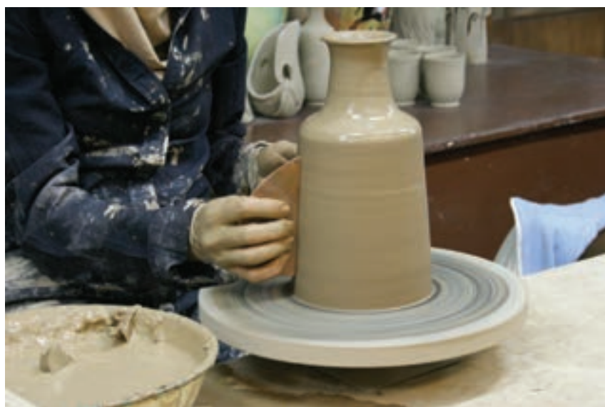
شکل ۸-۴-ح - پرداخت و شکل دادن با ابزار
