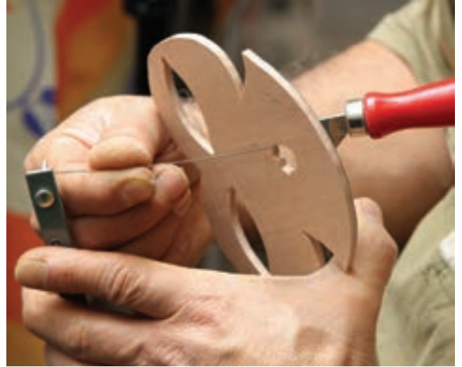
شکل ۲۰-۸-ب - برش قالب به قطعات کوچک تر
