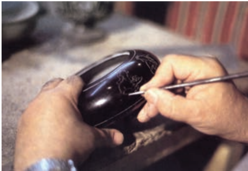
شکل ۱۵-۳- الف- مراحل کار حکاکی روی سنگ (انتقال طرح و دورگیری)
