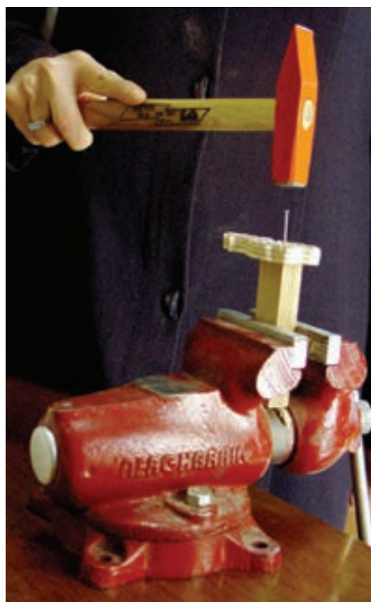
شکل ۱۸-۹- ب - اتصال سر قالب به دسته
