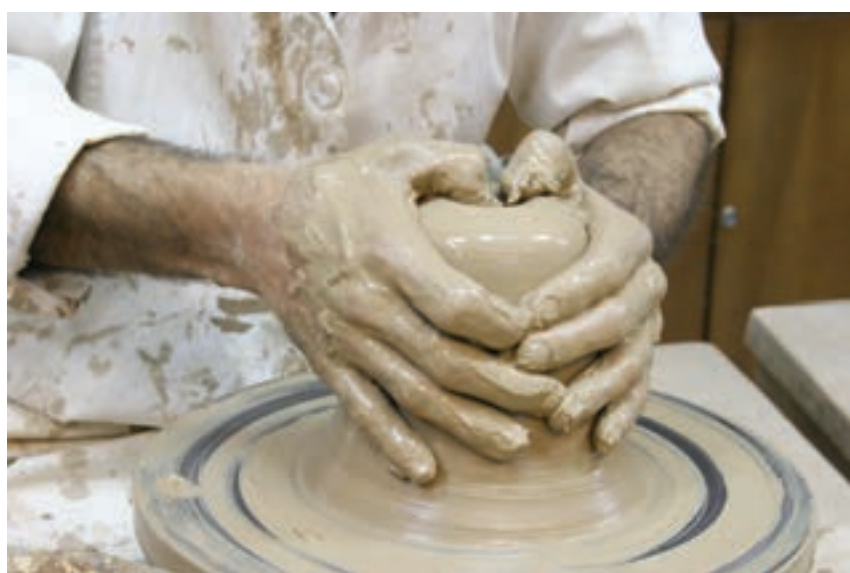
شکل ۸-۴-ج - هم مرکز کردن چانه با صفحه‌ی چرخ
