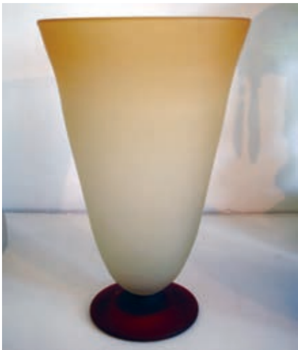
گلدان شیشه‌ای مات شده به روش شیمیایی
