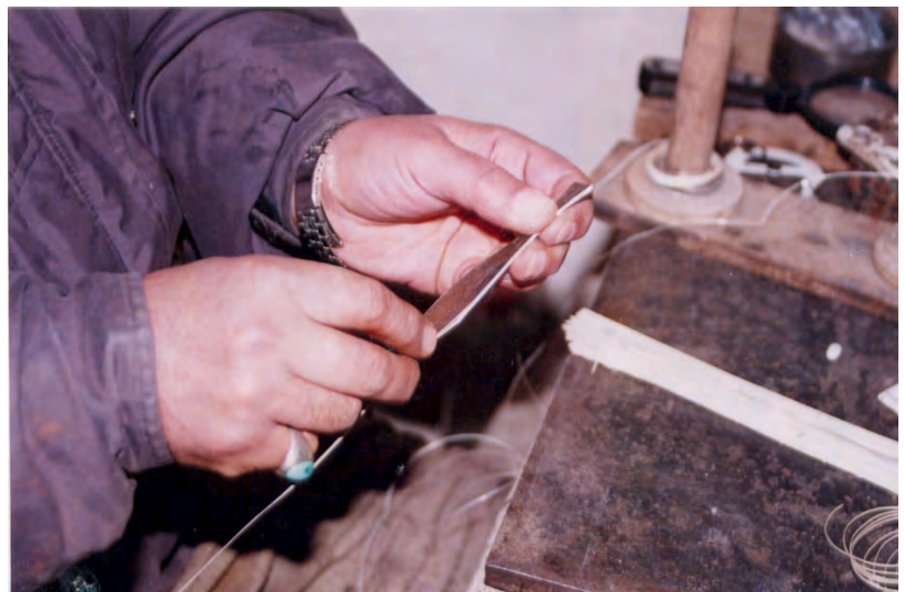
شکل ۱۱-۶-د - شکل دادن مفتول متناسب با طرح
