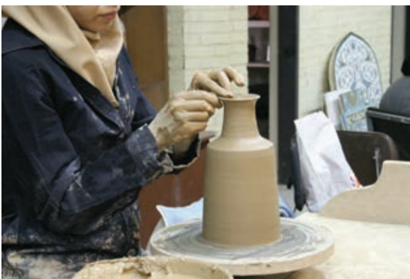
شکل ۸-۴-ز - شکل دادن لبه
