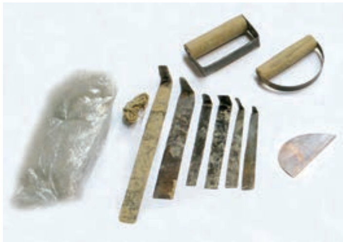
شکل ۴-۵- ابزار و وسایل شکل‌دهی بدنه‌ی گلی
