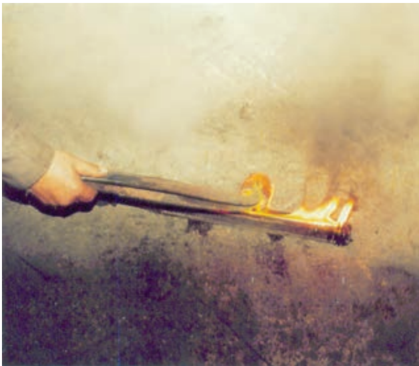
شکل ۱۱-۶- الف – تهیه‌ی مذاب نقره
