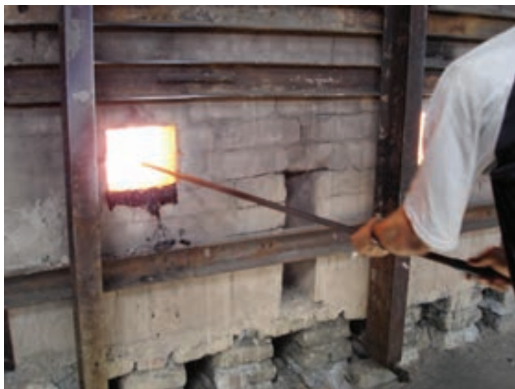
شکل ۷-۶ – مذاب شیشه در کوره (بارگیری)
