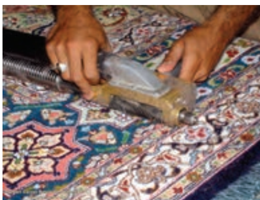
شکل ۲۶-۵- قیچی کاری صنعتی
