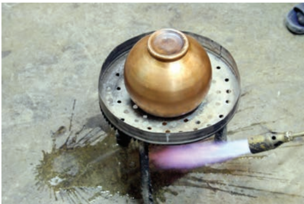
شکل ۱۹-۶ و - جداسازی قیر از شیء فلزی به وسیلهی حرارت پس از اتمام کار قلم‌زنی
