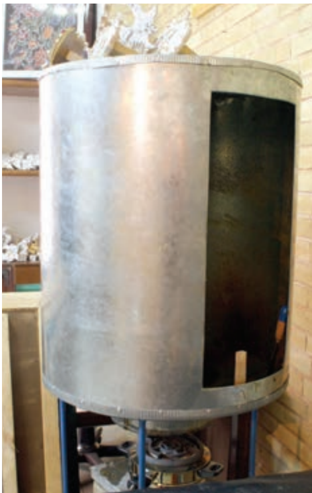
شکل ۹-۱۵- ب - منبع حرارتی و مخزن روغن کلاقه‌ای
