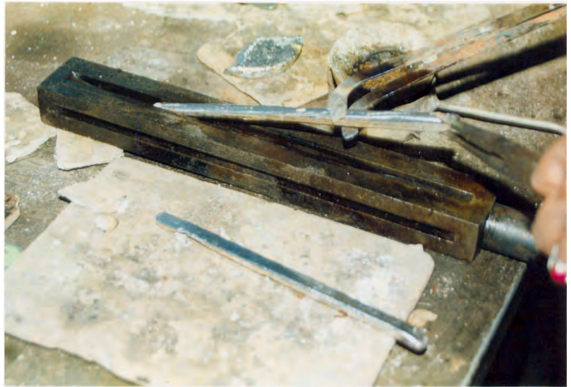
شکل ۱۱-۶-ب - تهیه‌ی شمش از مذاب نقره
