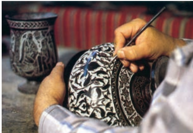
شکل ۱۵-۳- ب- مراحل کار حکاکی روی سنگ (خراش طرح)
