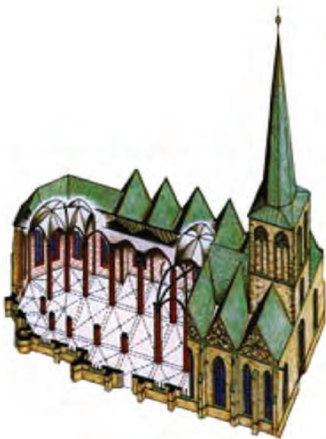
تصویر ۹- طرح کلی یک کلیسای گوتیک
