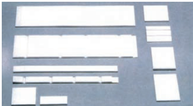
۱- قطعات بریده و زاویه خورده استایروفوم
