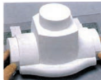
۵- هسته بلوفومی را روی یک صفحه پلاستیکی ثابت کنید.
