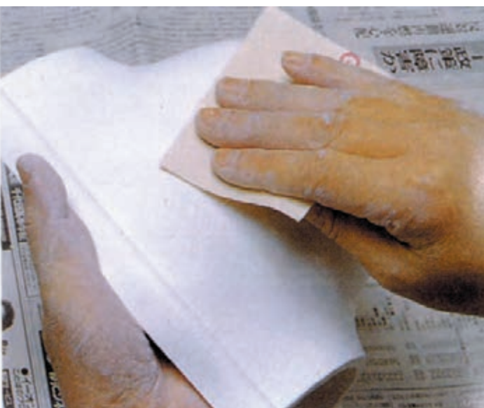
۲۰- سطح خارجی قطعه را پس از خشک شدن به آرامی با یک تکه سنباده بسایید.
