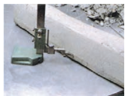
۵- به‌طور متناوب تقارن سطوح مدل بررسی و تراشیده می‌شود.
