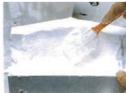
۱۶- گچ را درون قالب یک دست کنید.
