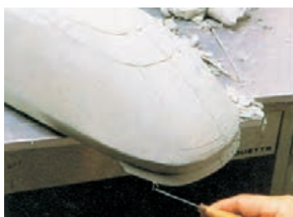
۳- با استفاده از راهنمایی خطوط، مدل برای رسیدن به طرح نهایی تراشیده می‌شود.
