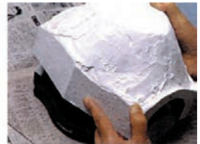
۱۲- پس از خشک شدن قالب گچی، آن را با اندکی حرکت دادن از روی مدل بردارید.
