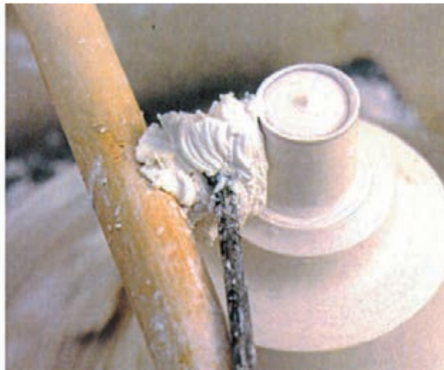
۷- قسمت دیگری از مدل با استفاده از یک تکیه‌گاه ساخته می‌شود.
