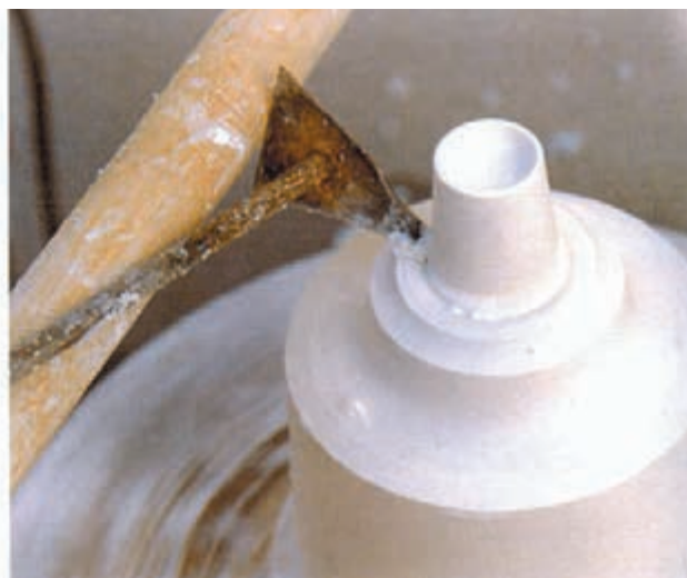
۹- مشخص کردن ارتفاع دقیق
