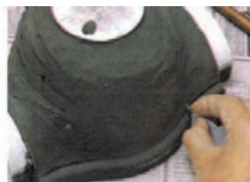
۷- از یک تیغه پلاستیکی به ضخامت یک میلیمتر به عنوان شابلون لبه گیری مدل استفاده کنید.
