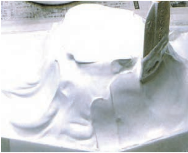
۱۱- با استفاده از کاردک گچ ریخته شده در قالب را یک دست کنید.
