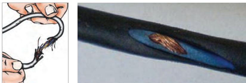
شکل ۱۸-۳- پوسیدگی و زخمی شدن سیم‌ها و کابل‌ها
