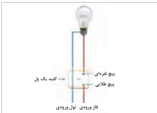
شکل ۳-۳۵- مدار الکتریکی کلید یک پل
