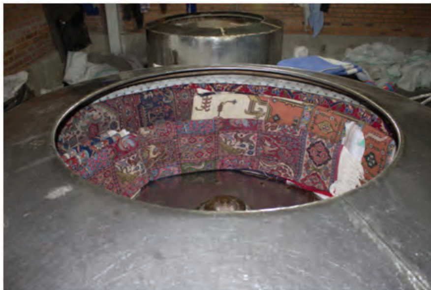
شکل ۱۱۱ - دستگاه آبگیری فرش
