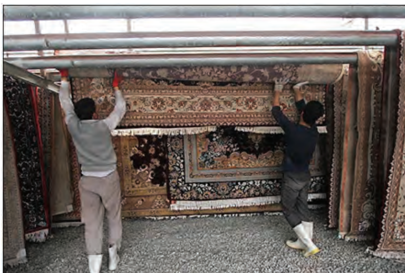
شکل ۱۱۲- عملیات پهن و خشک کردن فرش
