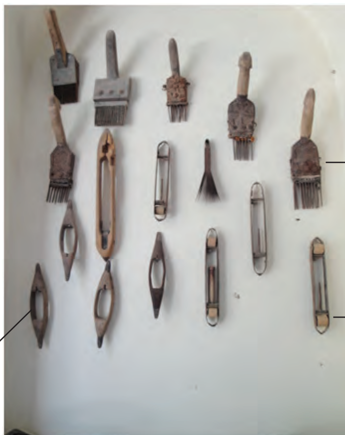
شکل ۴۷- برخی از ابزار بافت جاجیم و زیلو
