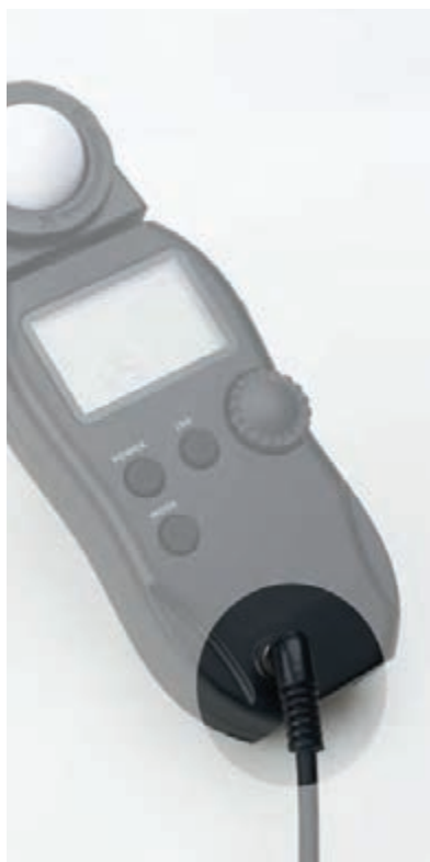
▲ تصویر ۱۹۵ | اتصال سیم سینکرون به نورسنج
