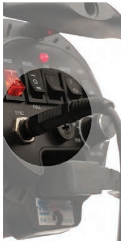
▲ تصویر ۱۹۶ | اتصال سیم سینکرون به فلاش
