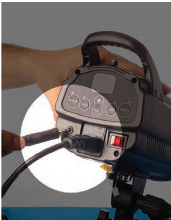
▲ اتصال سیم سینکرون رادیوتریگر به فلاش | تصویر ۱۳۶
