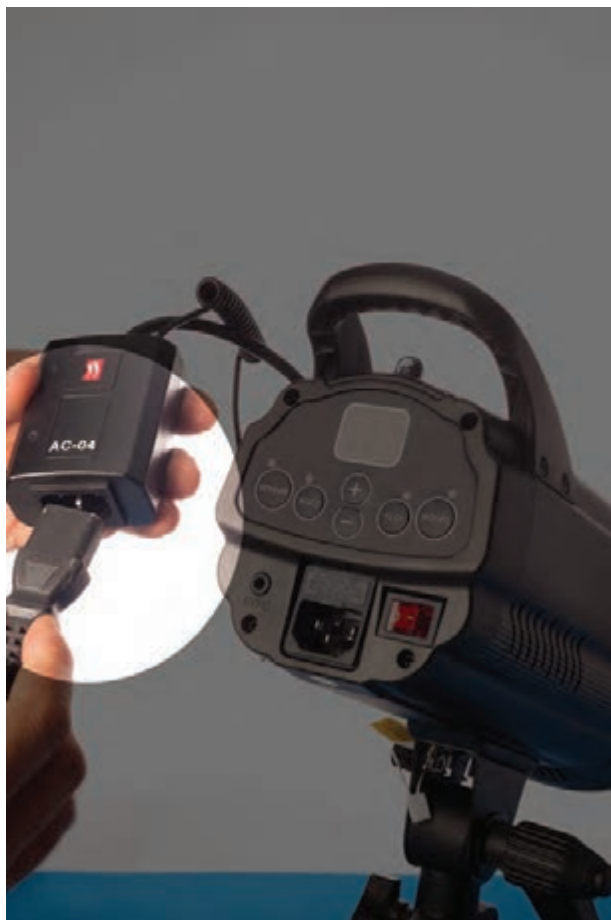
▲ اتصال گیرنده راديو تريگر به برق در مدل های برقی | تصویر ۱۳۴
