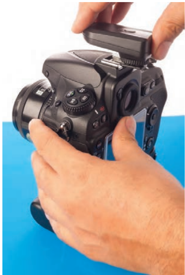
▲ اتصال ريموت فرستنده به دوربین | تصویر ۱۳۵
