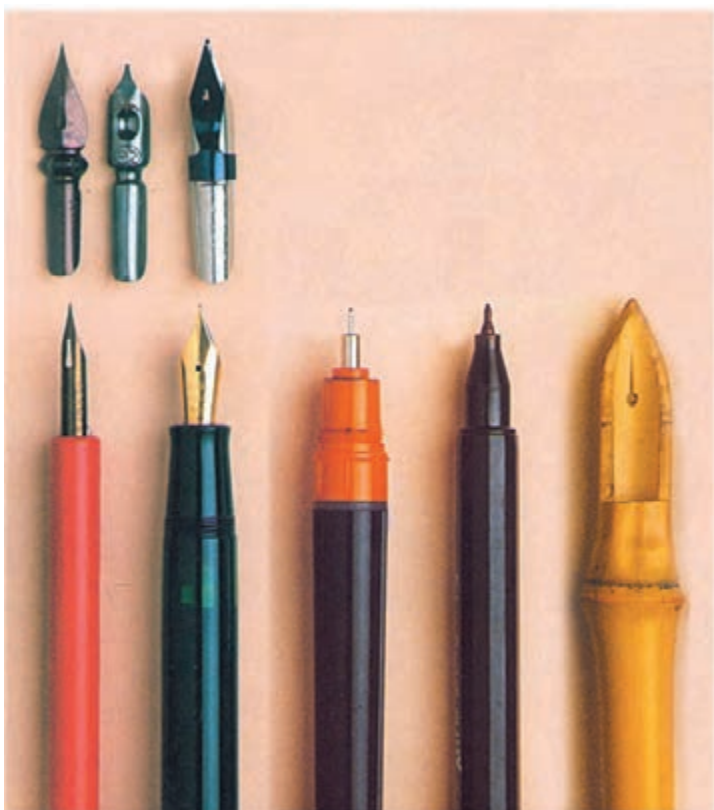
از راست به چپ: قلم نی، روان نویس، راپیدوگراف، خودنویس، قلم آهنی (با چند نوع نوک اضافه که می توان بر بدنه آن سوار کرد).
