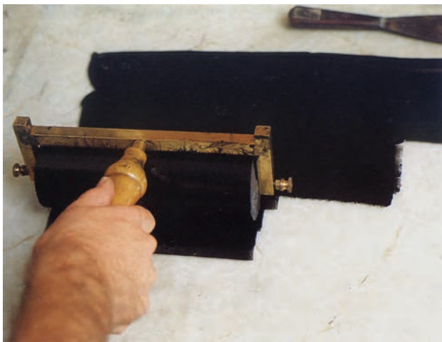
تصویر ۶۰- پخش کردن مرکب روی سطح شیشه
