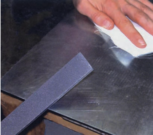
تصویر ۱۷۷- گرد کردن لبه‌ها و گوشه‌ها با سوهان (و سپس سنباده نرم)
